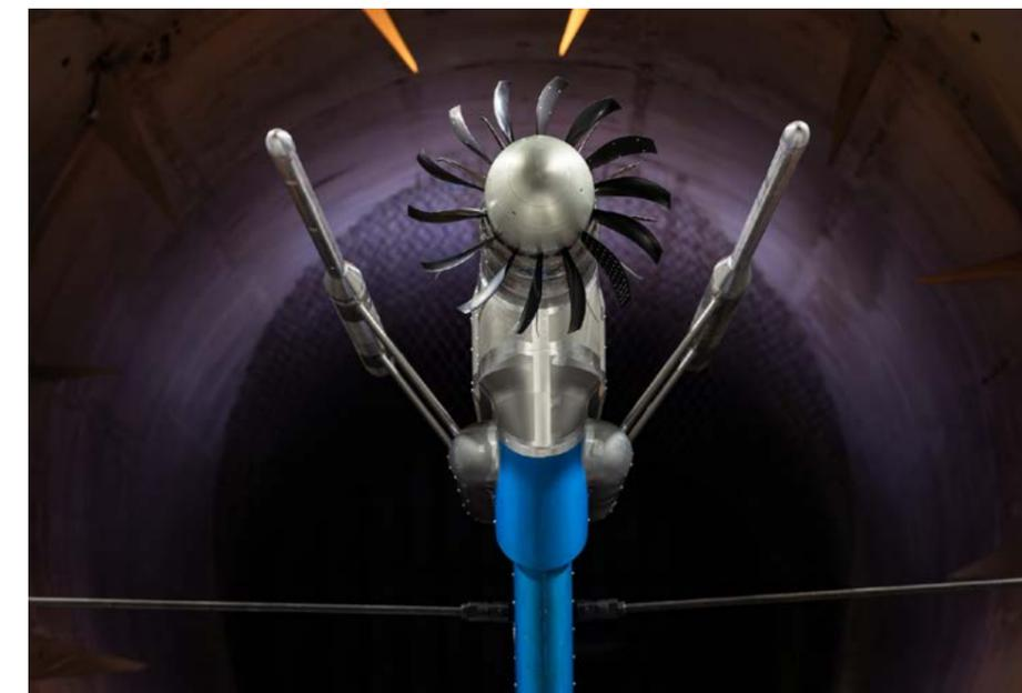
L'Open Rotor, en cours de validation, est une architecture de propulsion disruptive visant une aviation plus efficace. Ce projet ECOENGINÉ (lire pages 46 et 47) de Safran, soutenu par la DGAC et testé à l'ONERA en 2024, symbolise l'engagement de l'industrie pour maîtriser les défis technologiques majeurs de l'aérodynamique et de l'acoustique, étapes cruciales vers une propulsion plus durable. © Safran
