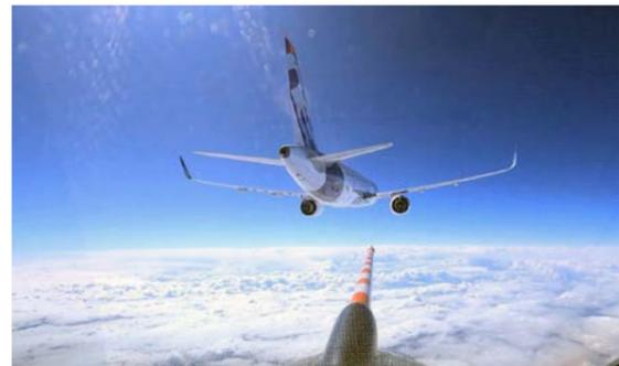
Mesure des émissions grâce à un Falcon DLR. © DLR aviation
