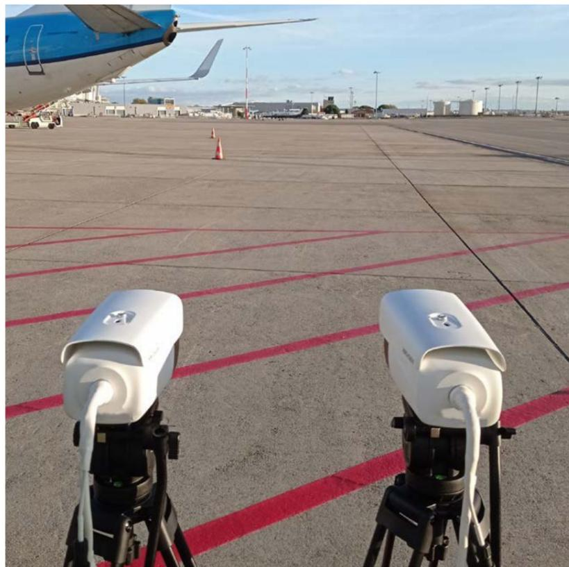
Expérimentation de caméras thermiques par le STAC sur l'aéroport de Toulouse-Blagnac. © Maxandre Coulon/DGAC-STAC
