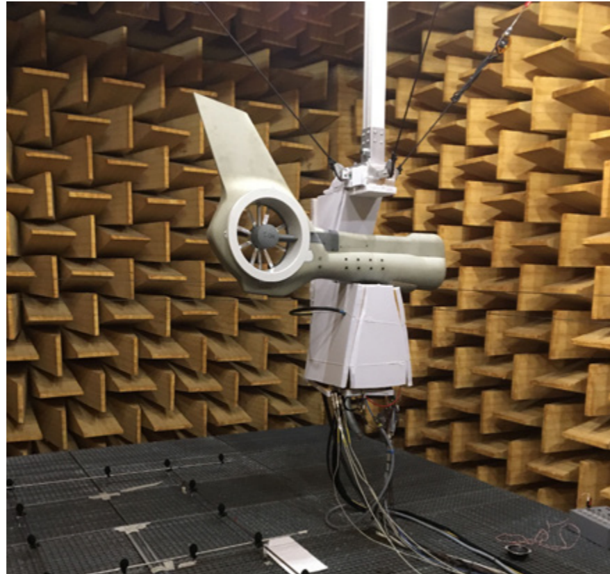
Essai en chambre anéchoïde pour le traitement acoustique du fenestron, à l'Onera.
