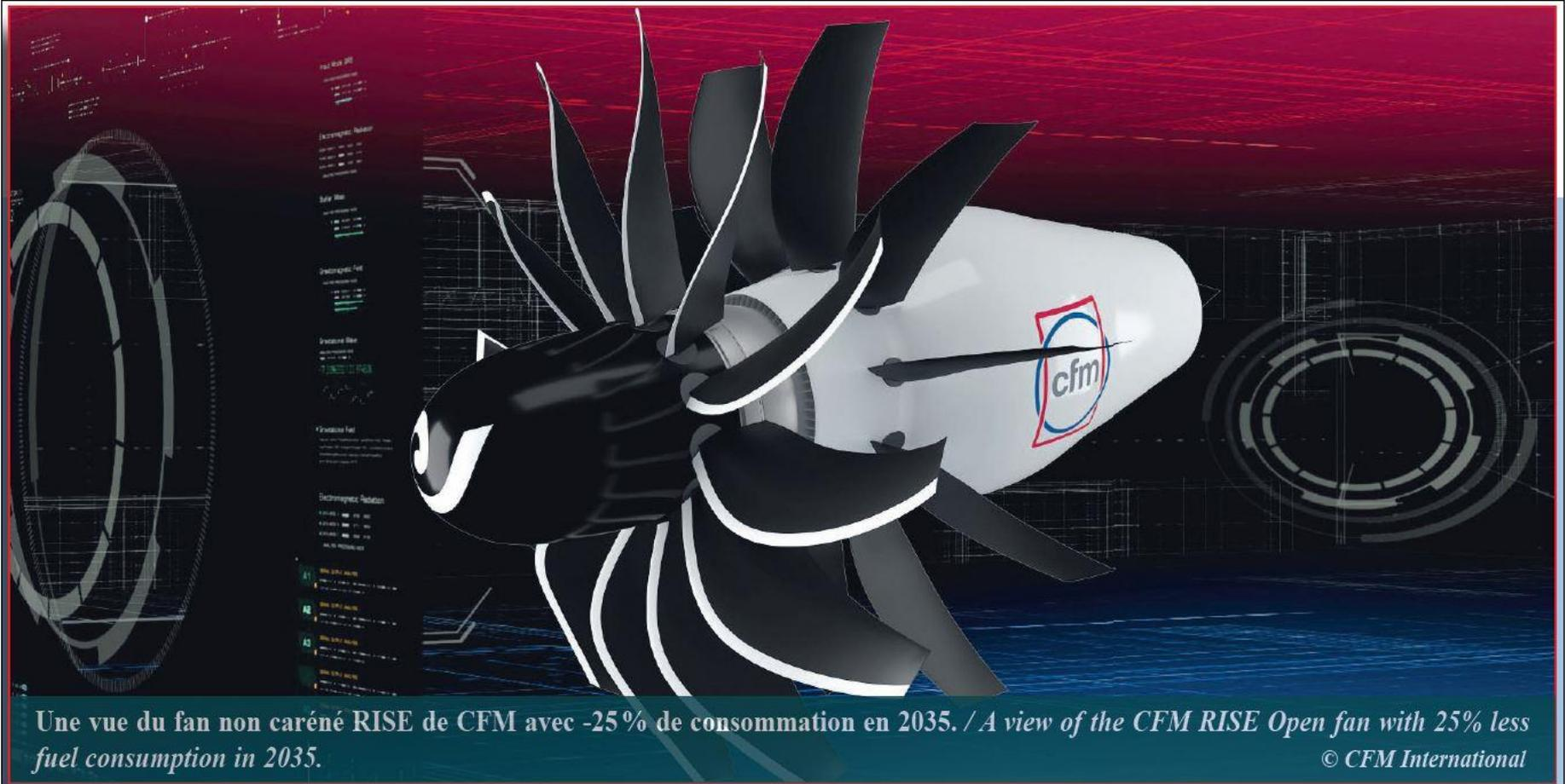
Une vue du fan non caréné RISE de CFM avec -25% de consommation en 2035. / A view of the CFM RISE Open fan with 25% less fuel consumption in 2035.
